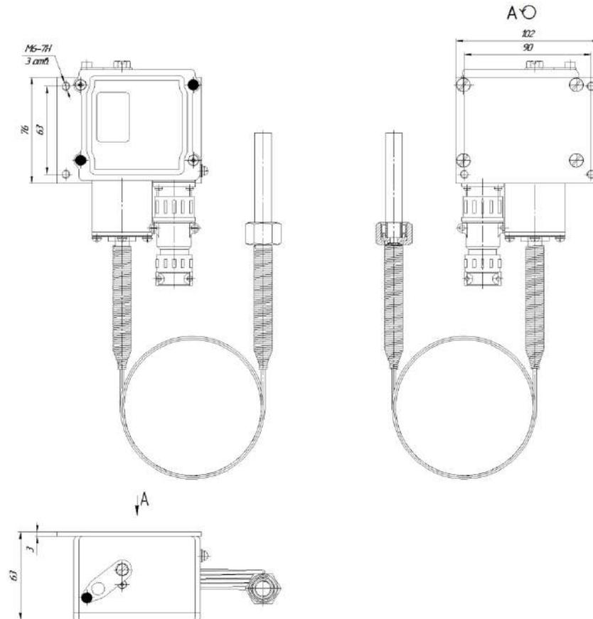
Рисунок А.5 – Крепление прибора с монтажным комплектом КЗ
