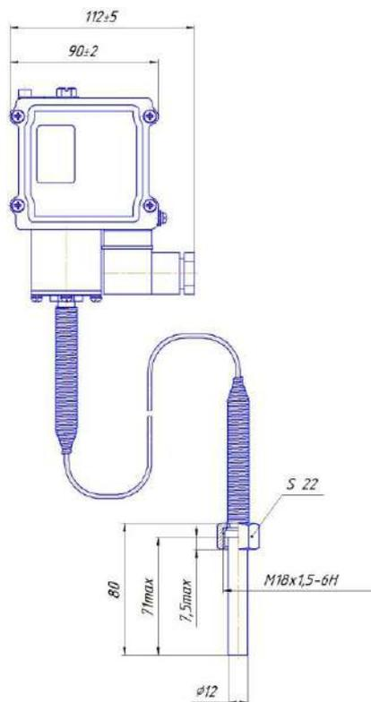
Рисунок А.6 – Крепление прибора гайкой M18x1,5 (перенести)
