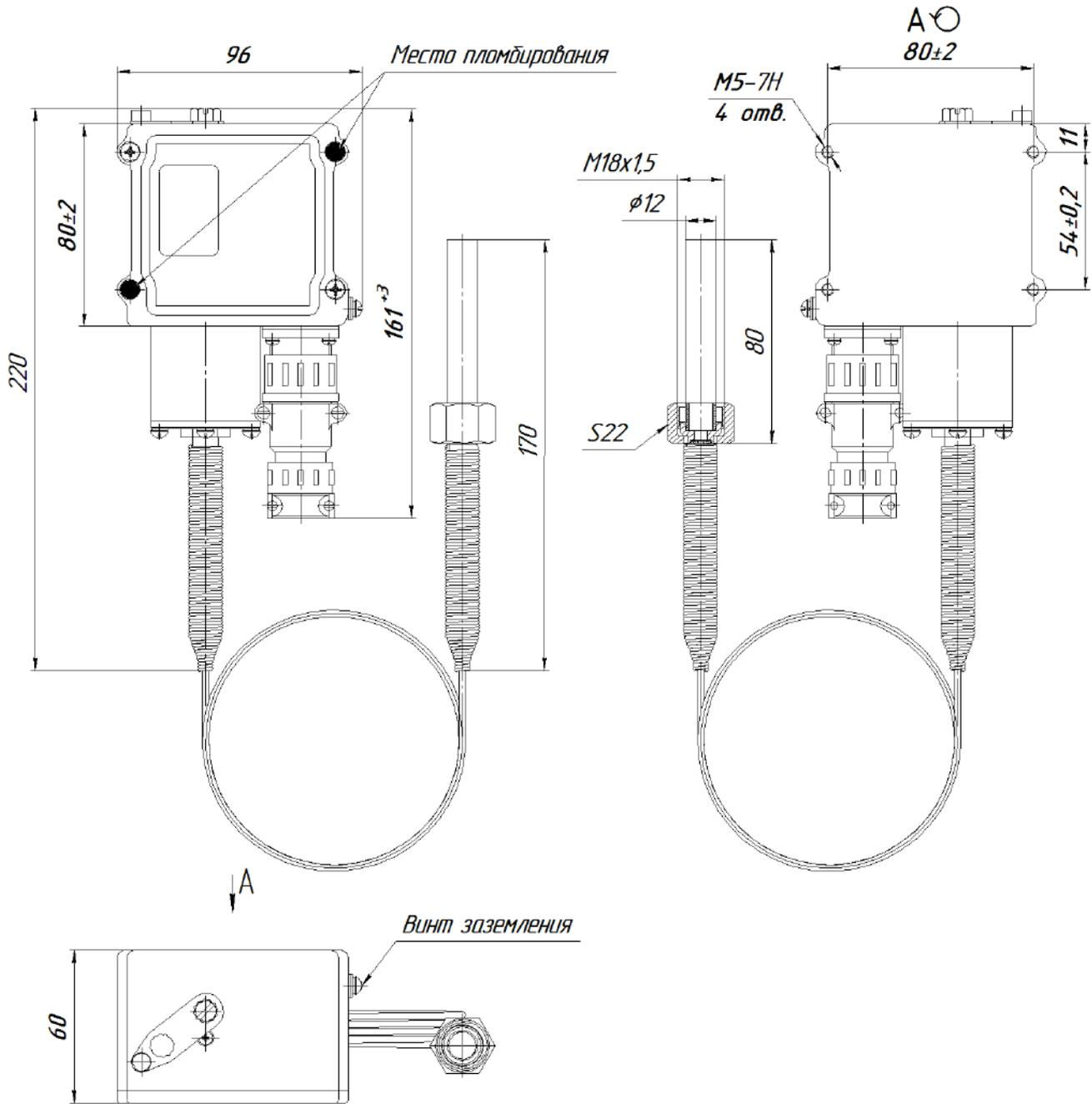
Рисунок А.2 – Габаритные и установочные размеры прибора с соединителем типа 2PRT, ШР
