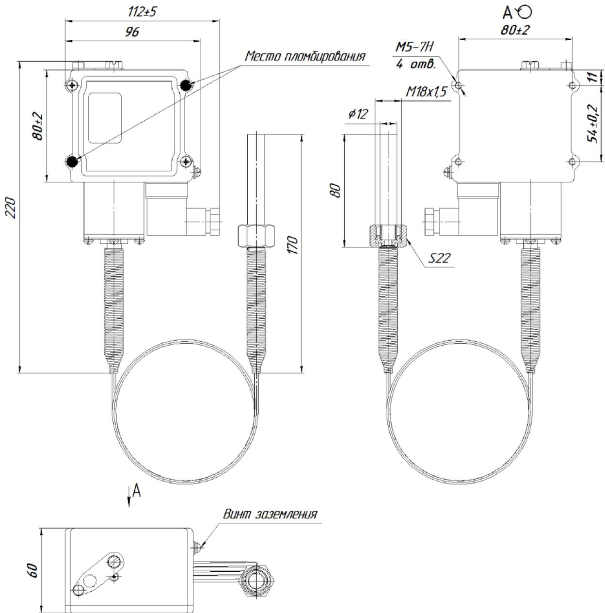
Рисунок А.1 – Габаритные и установочные размеры прибора
